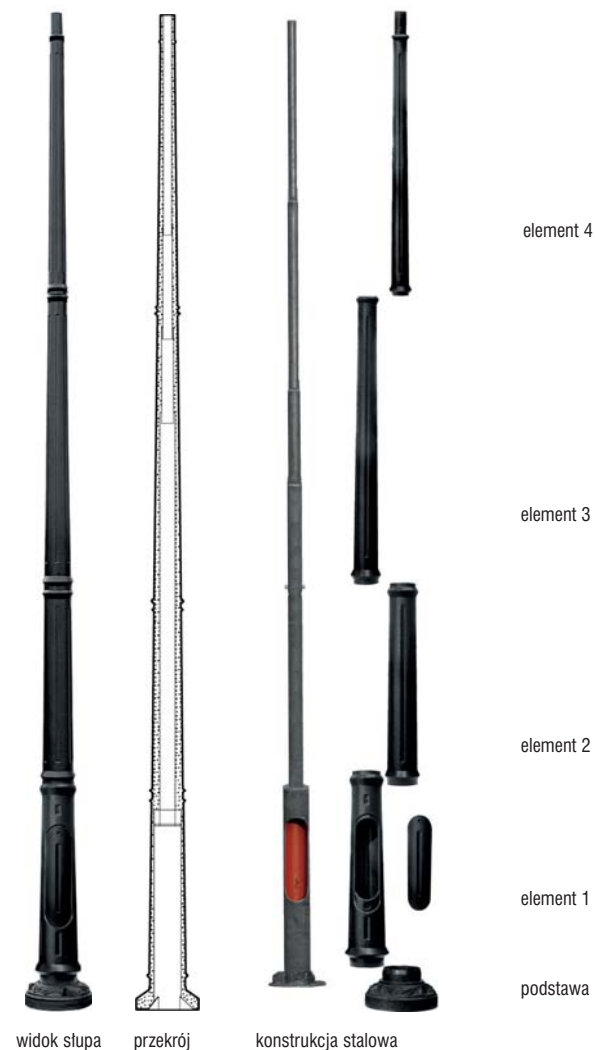
Przykład budowy słupa SP-4 W
